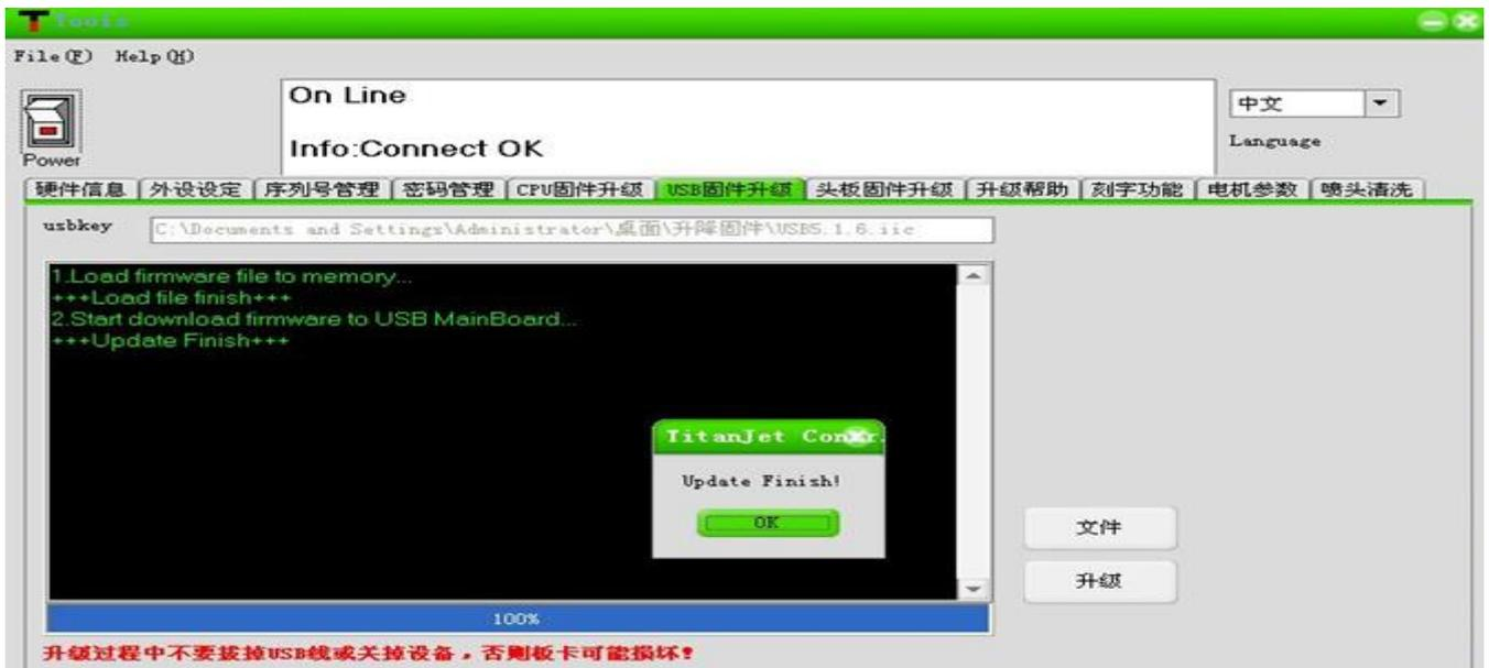
17: 升级完毕后, 先关掉 mainboard.exe 工具软件, 关掉电源, 恢复 USB 保护帽, 然后再次打开电源, 打开 mainboard.exe 工具软件, 连接成功后, 点击硬件信息, 可以看到主板 MCU 和 USB 的固件版本, 若版本信息显示是最新的版本, 则表示升级成功。
