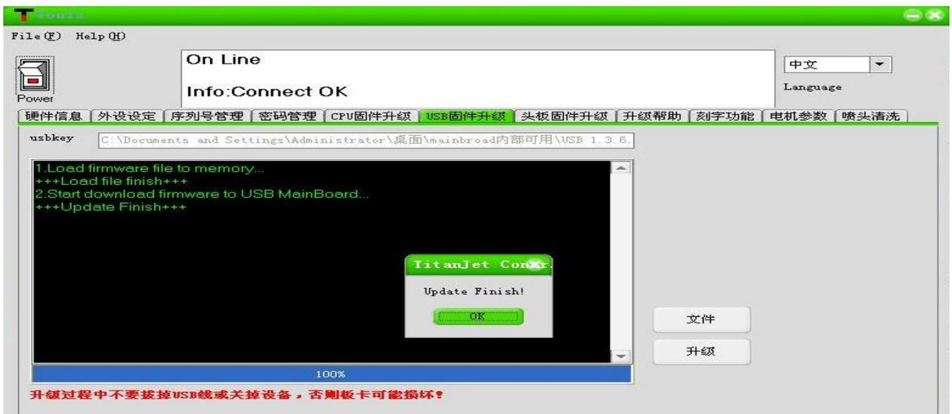
17: 升级完毕后, 先关掉 mainboard.exe 工具软件, 关掉电源, 恢复 USB 保护帽, 然后再次打开电源, 打开 mainboard.exe 工具软件, 连接成功后, 点击硬件信息, 可以看到主板 MCU 和 USB 的固件版本, 若版本信息显示是最新的版本, 则表示升级成功。
