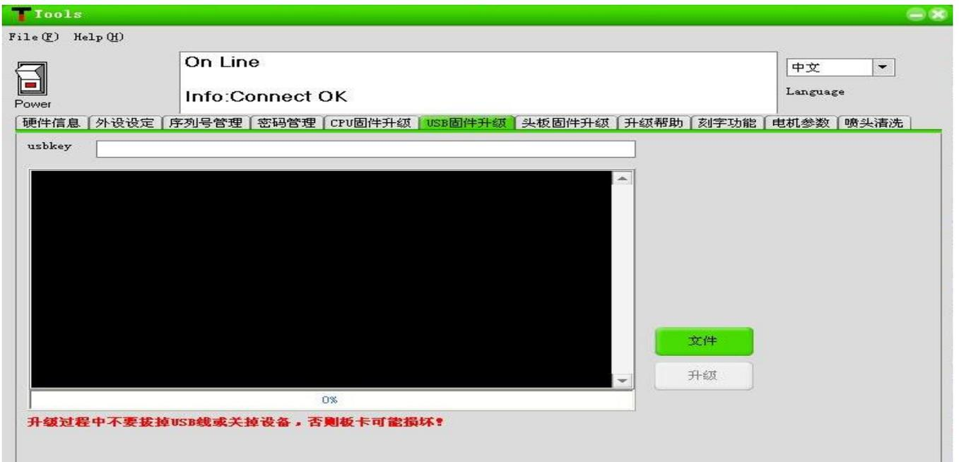
13: 在弹出的对话框中，找到最新 USB 固件：USB5.1.6.iic，选中，点击“打开”。
