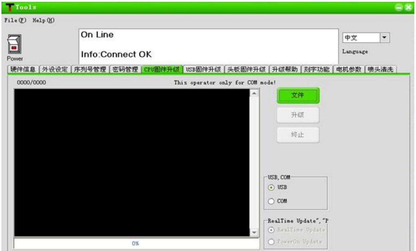
7: 在弹出的对话框中，找到最新主板 MCU 固件：MB1.2.9.bin，选中，点击“打开”。
